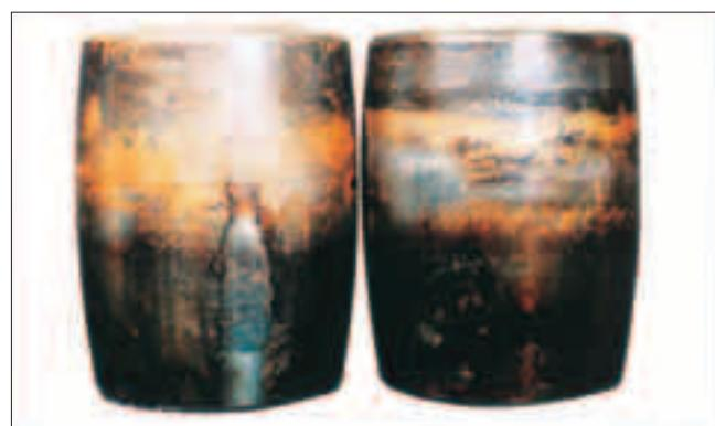
Часть: Выпуклые ролики сферического роликоподшипника
