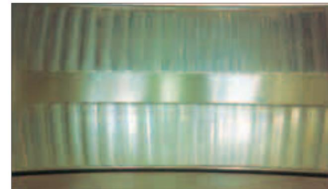
Часть: Внешнее кольцо сферического роликоподшипника
