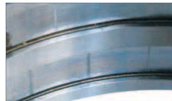
Часть: Внешнее кольцо цилиндрического роликоподшипника в два ряда
