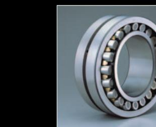
Серия подшипников CA - это самоустанавливающиеся сферические роликоподшипники в два ряда с фрезерованным латунным сепаратором с высокой максимальной нагрузкой, великолепной прочностью и износостойкостью. Серия CA особенно подходит для применения при работе в условиях тяжелых и ударных нагрузок.
