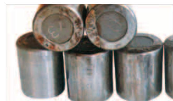
Часть: Конические ролики конического роликоподшипника в два ряда
