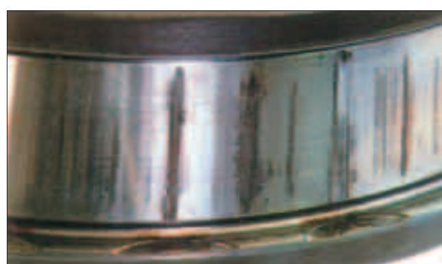
Часть: Внутреннее кольцо конического роликоподшипника в два ряда
