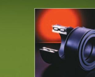
Комплектные цилиндрические роликоподшипники в два ряда с тонким профилем, но широкие специально сконструированы для блоков троса крана. Другие применения включают машины, работающие при низких скоростях и высоких нагрузках. Эти неразъемные подшипники могут выдерживать тяжелые ударные нагрузки и мгновенные нагрузки, а также значительные осевые нагрузки при использовании в блоках.
