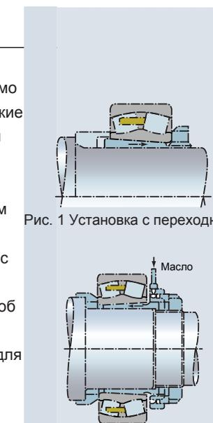
Рис. 1 Установка с переходником
