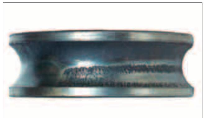
Часть: Внутреннее кольцо контактного радиально-упорного шарикоподшипника
