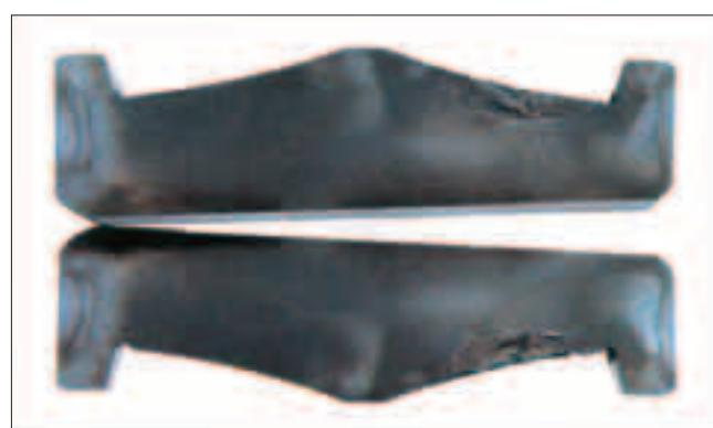
Часть: Поперечное сечение сломанного внутреннего кольца сферического роликоподшипника
