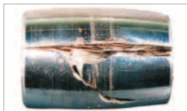
Часть: Ролик сферического роликоподшипника
