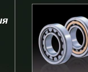
Серии подшипников EM и EW - цилиндрические роликоподшипники, воспринимающие очень большие радиальные нагрузки и подходящие для применения при больших скоростях. Серия EW характеризуется штампованным стальным сепаратором, а серия EM - неразъемным фрезерованным латунным сепаратором. Оба сепаратора предлагают высокую максимальную нагрузку для подшипников стандартного размера, а также превосходную функциональность и более длительный срок службы.
