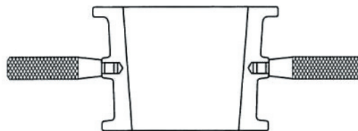
Рис. 3.6 Конусный калибр для измерения конусности шейки прокатного вала
