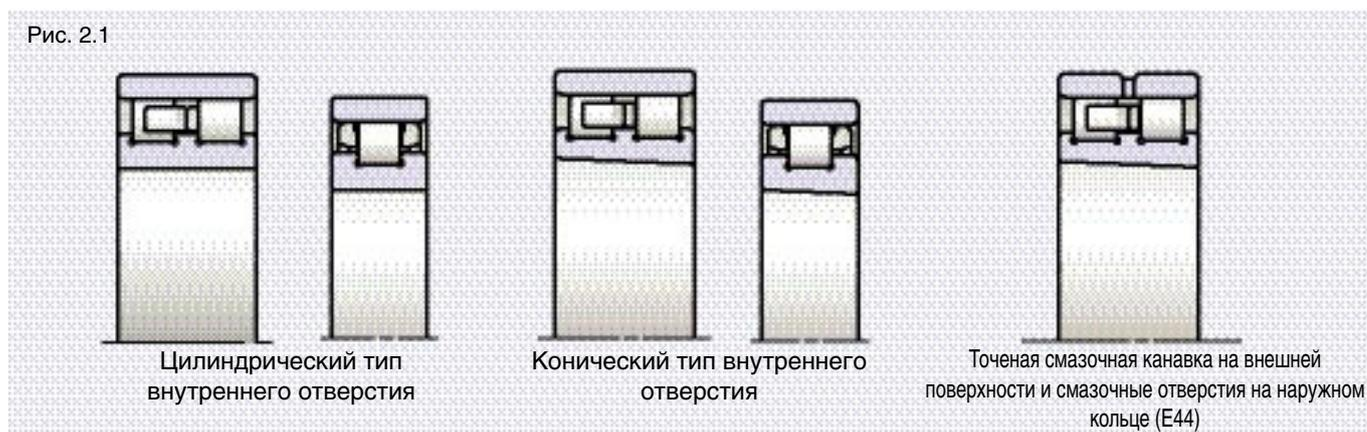
Двухрядные и однорядные подшипники, выпускаемые с цилиндрическим или коническим внутренним отверстием. Двухрядные цилиндрические роликовые подшипники, выпускаемые с точеной смазочной канавкой и смазочными отверстиями (лучшее решение для смазывания жидким смазочным материалом).
