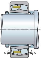
Таблица 1. Радиальный зазор в сферических роликоподшипниках с конусным отверстием
