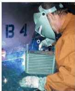
Фиг. 2. MIG сварка тонкостенных теплообменников из сплавов серии 3xxx (алюминий/марганец) с использованием в качестве присадочного материала сплава 4047 (12% Si) существенно отличается от процесса сварки, изображенного на фиг. 1
