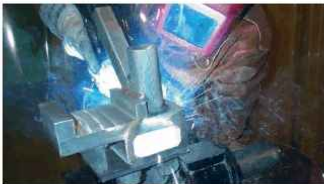
Фиг. 1. MIG сварка со струйным переносом металла толстостенных изделий из сплавов серии 6xxx (системы Al/Mg/Si) при использовании в качестве присадочного материала сплава 5356 (5% Mg)
