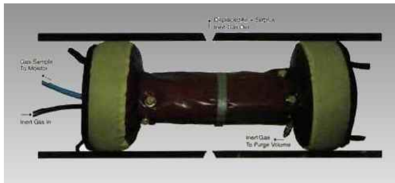
Рис. 4 Надувная система быстрой продувки труб в поперечном сечении, которая показывает направление движения газа и пробоотборное отверстие для кислорода.
