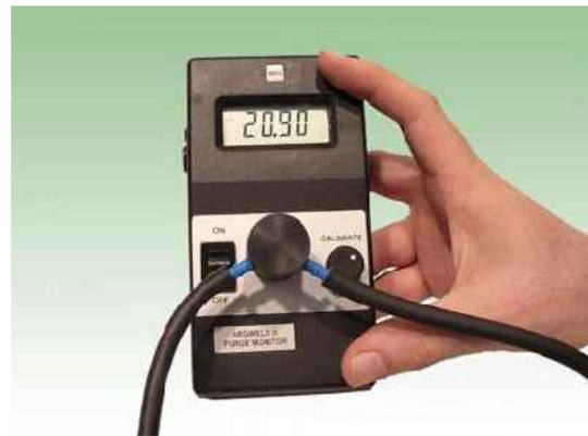
Перед началом сварочных работ с использованием инертного газа необходимо убедиться в том, что содержание кислорода в зоне сварки сократилось до достаточно низкого уровня.
