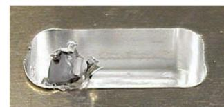
Обработка твердосплавной концевой фрезой без покрытия
